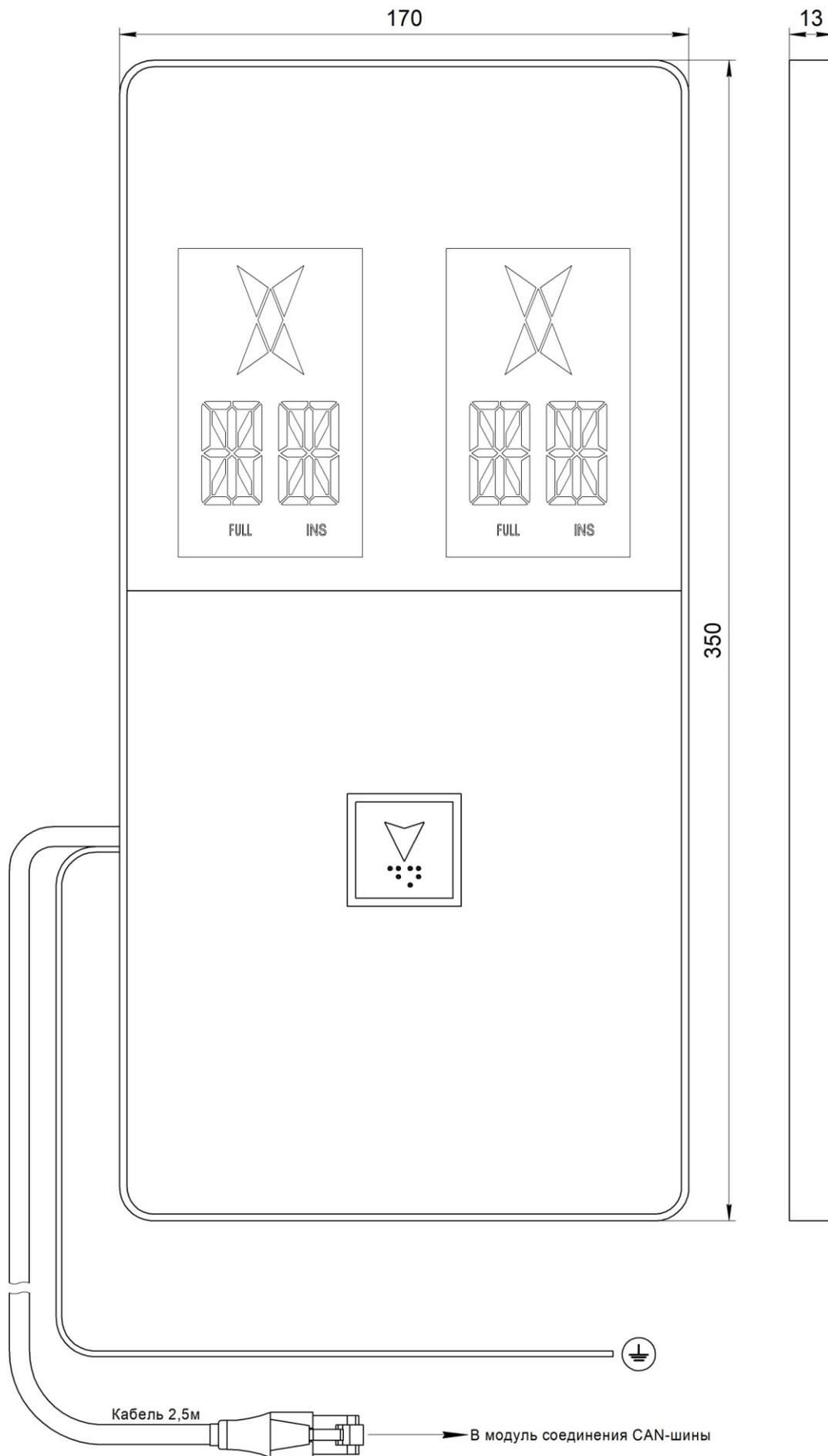
Рис.1 Внешний вид, габаритные и установочные размеры Вызывного поста МАЛАХИТ (жгут RJ45) НШЕК.468381.111
